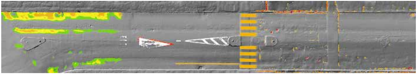
5 | Les déformations, la signalisation horizontale et les dégradations extraites par télédétection. 5 | Verformungen, horizontale Signalisation und durch Fernerkennung festgestellte Zustandsverschlechterungen.
